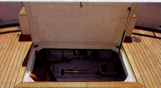
Dal portello in pozzetto si ispezionano gli impianti e si accede ai motori.
